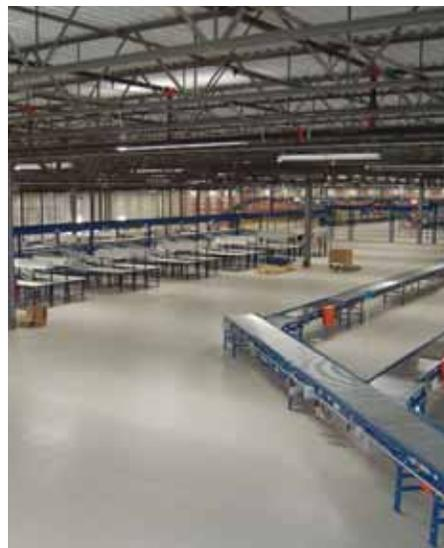
ResinDek<sup>®</sup> ESD proporciona también una superficie resistente al derrape, mancha, arañazos y una resistencia tal que no se deslaminará como otros materiales para entornos. Se instala fácilmente sobre planchas de lamina estructural con los sujetadores recomendados.
