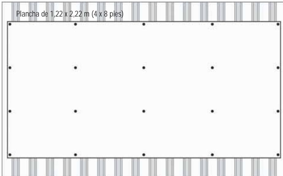
**Figura B** arreglo de tornillos de la parte superior
