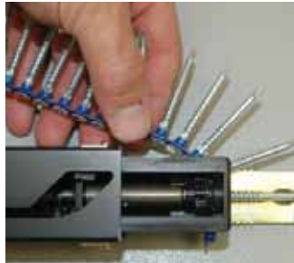
Mueva la tira hacia adelante hasta que el primer tornillo esté alineado con la broca. Esto permitirá el avance correcto de la tira una vez que se libere el cabezal.
