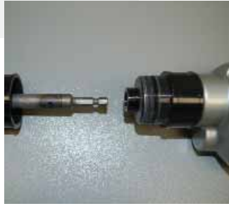
Introduzca la varilla interior en el centro del adaptador de la pistola. Presione hasta que la varilla se asiente en su lugar. Deslice el poste exterior de extensión sobre la varilla interior y asegúrela roscándola en el adaptador de la pistola.
