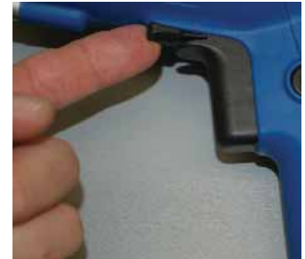
Asegure que la pistola esté operando en la modalidad "adelante" (de las agujas del reloj). Si no, el tornillo no avanzará y la broca se dañará.
